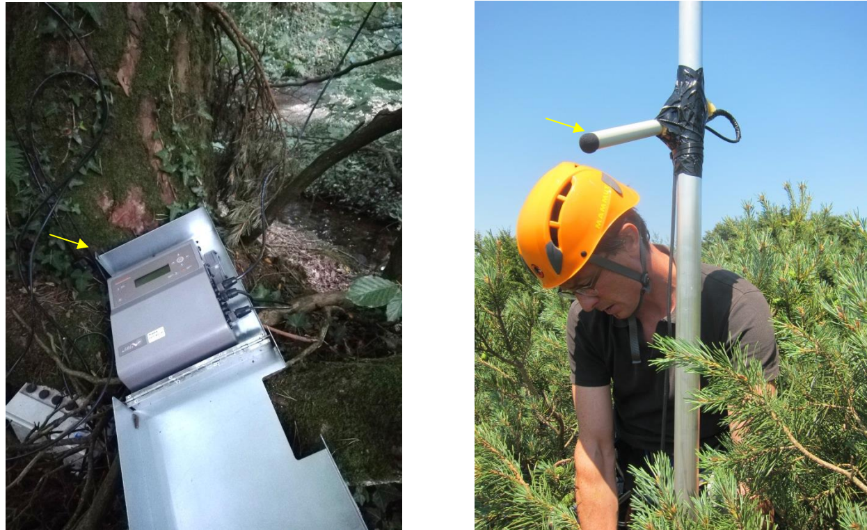
Figure 18. Photographies de l'enregistreur SM3BAT et micro sur perche en canopée installés en 2018 et 2019
